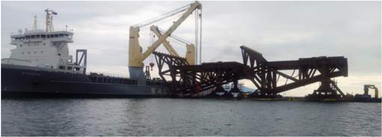
Operazioni di sbarco dalla nave heavy lifter Svenja di due piattaforme utilizzate per la realizzazione del fondo artificiale all'isola del Giglio
