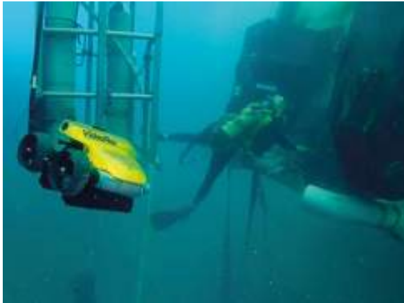
Un roV VideoRay a supporto del lavoro dei sommozzatori
